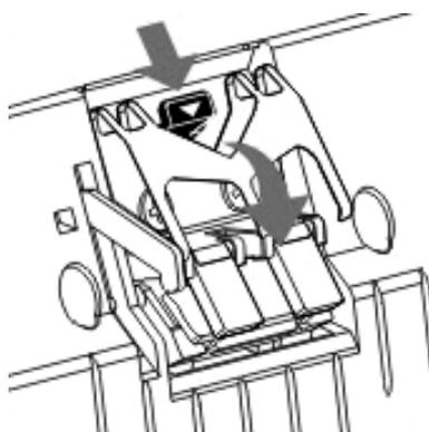
3. Installez le nouveau module d'extension en enclenchant les pions du module dans leurs supports sur le scanner.
