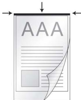
6. Chargez la feuille de protection dans le scanner et alignez la feuille de protection avec la ligne noire vers le centre du chargeur.
